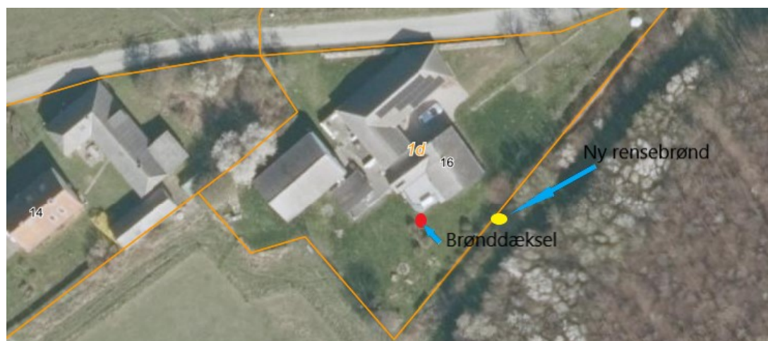
Figur 11. Placering af ny rensebrønd (gul prik) på Naturstyrelsens dræn. Placering af brønddæksel ved bundfældningstank (rød prik) på Søgårdsvej 16.
