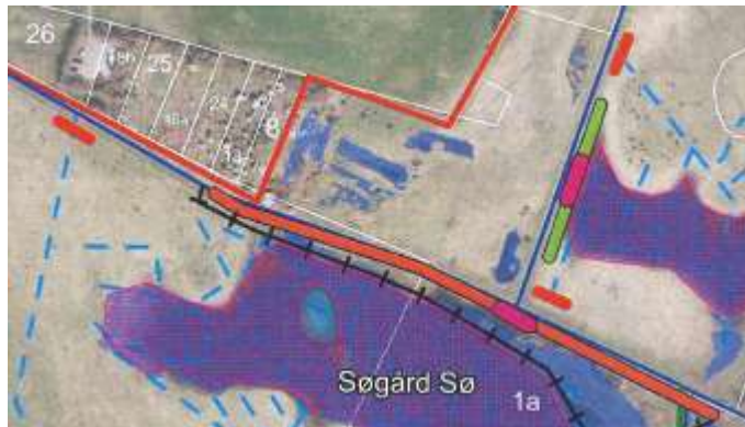
Figur 16 De 3 drænudløb er markeret med rød signatur henover det blå dræn
